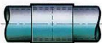
**ЗАЖИМНАЯ МУФТА:** прямой трубопровод или фитинги соединяются вместе снизу, закрепляются вокруг муфтой.
